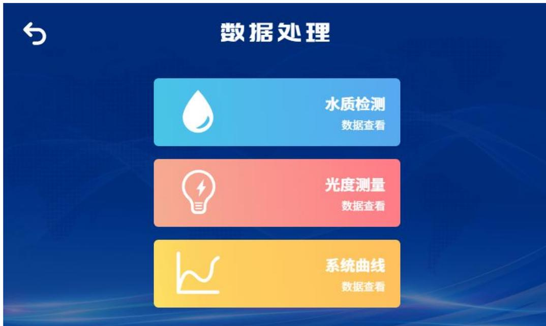
对水质检测、光度测量、系统曲线的数据进行查看、删除、打印、U 盘导出等操作。U 盘格式(支持 FAT12、FAT16、FAT32), 容量最大支持 32GB。
