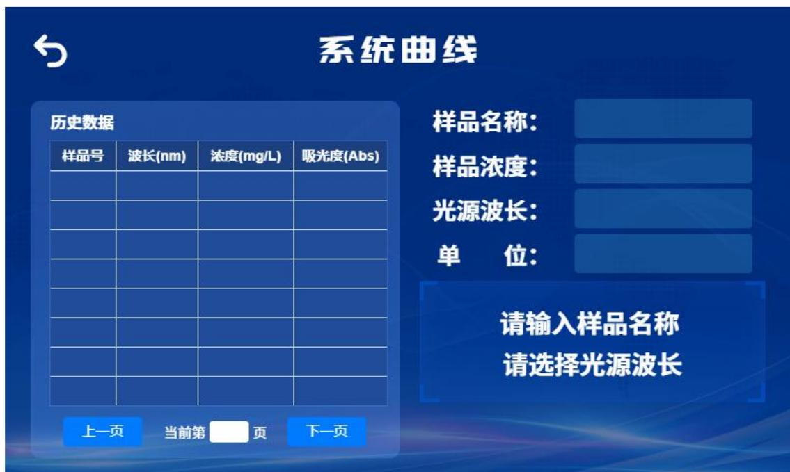
(1) 根据提示输入样品名称和光源的波长，根据提示放入空白液进行清零校准。
