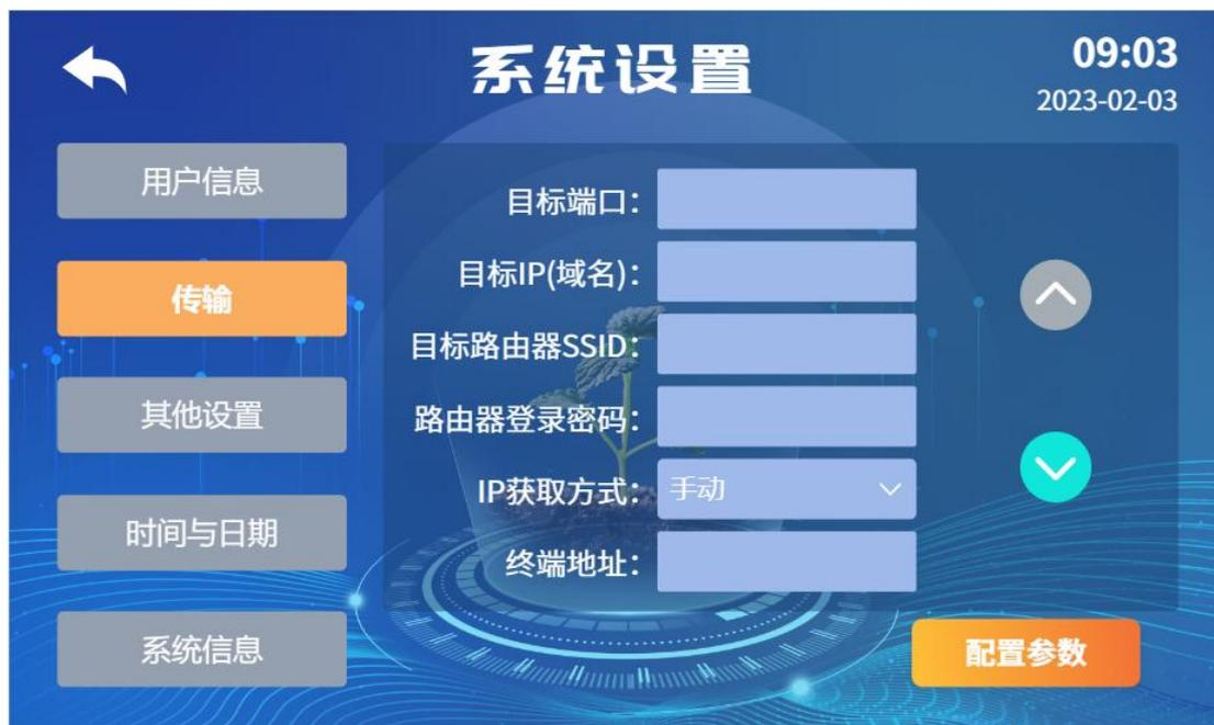
输入目标端口、目标 IP、目标路由器 SSID、路由器登录密码通过 WIFI（可选 4G）上传平台
